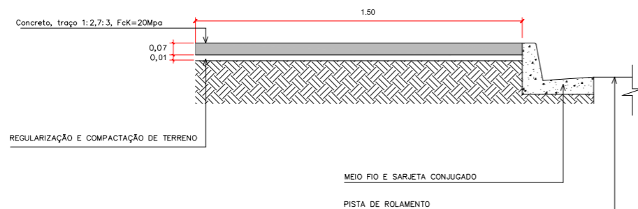
SEÇÃO TRANSVERSAL DA CALÇADA SEM ESCALA
