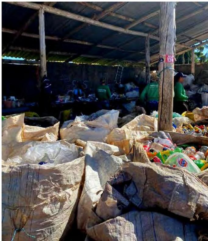
Figura 49 - Mesa selecionadora para separação manual para triagem de resíduos recicláveis da COOPCHAMAR. Fonte: levantamento de campo, maio de 2023.
