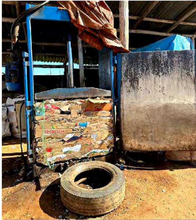
Figura 51 - Detalhe da prensa enfardadora utilizada para compactação dos resíduos já separados após a triagem. Fonte: levantamento de campo, maio de 2023.
